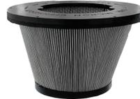
Die Abscheidung erfolgt über eine BIA- Klasse M Filterpatrone mit einem Abscheidegrad von 99,9%. Eine hohe Filterfläche sorgt für lange Standzeiten. Das bedeutet, dass alle Partikel bis zu einer Korngröße von 1µ abgeschieden werden. Motoren und Bediener werden somit vor Schmutzbelastungen geschützt.
