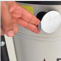
Der XM35 ist mit dem Jetclean- Abreinigungssystem ausgestattet. Über eine manuell zu öffnende Klappe strömt während des Betriebs Luft in die Kammer des Saugers. Durch den entstehenden Sog verwirbelt die Luft im Gehäuse und reinigt das Filterelement ab. Ein optionaler manueller Absperrschieber verriegelt die Zuluft des Ansaugstutzen und erhöht die Effizienz der Abreinigung. Nach der Entriegelung des Absperrschiebers kann die Absaugung fortgeführt werden.
