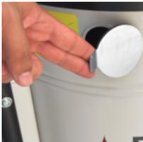
Der XM35 ist mit dem Jetclean- Abreinigungssystem ausgestattet. Über eine manuell zu öffnende Klappe strömt während des Betriebs Luft in die Kammer des Absaugers. Durch den entstehenden Sog verwirbelt die Luft im Gehäuse und reinigt das Filterelement ab. Ein optionaler manueller Absperrschieber verriegelt die Zuluft des Ansaugstutzen und erhöht die Effizienz der Abreinigung. Nach der Entriegelung des Absperrschiebers kann die Absaugung fortgeführt werden.
