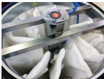
PSC Halbautomatischer pneumatischer Filtrerrüttler
