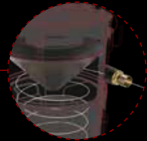
Tangentialeinlass mit Zyklon
