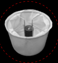
P09679: PPL-Filter (150u) + Metallsieb + Schwimmer zur automatischen Unterbrechung der Absaugung
